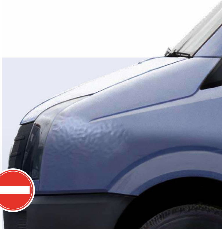
Peinture imparfaite de la carrosserie, avec boursouflures ('peau d'orange') et coulées
